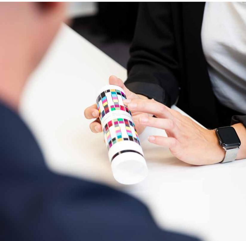
GMG OpenColor: wissen, was an der Maschine passiert. Weil die Tube als Schlauch bedruckt wird, muss dieser zum Einmessen der Patches aufgeschnitten und auf eine flache Unterlage geklebt werden.
